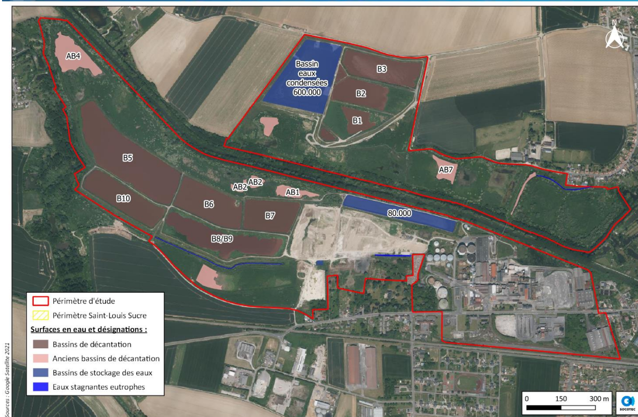
Figure 13 : Localisation et identification des différents bassins de décantation (actuels et anciens) ainsi que des zones de stockage d'eau
